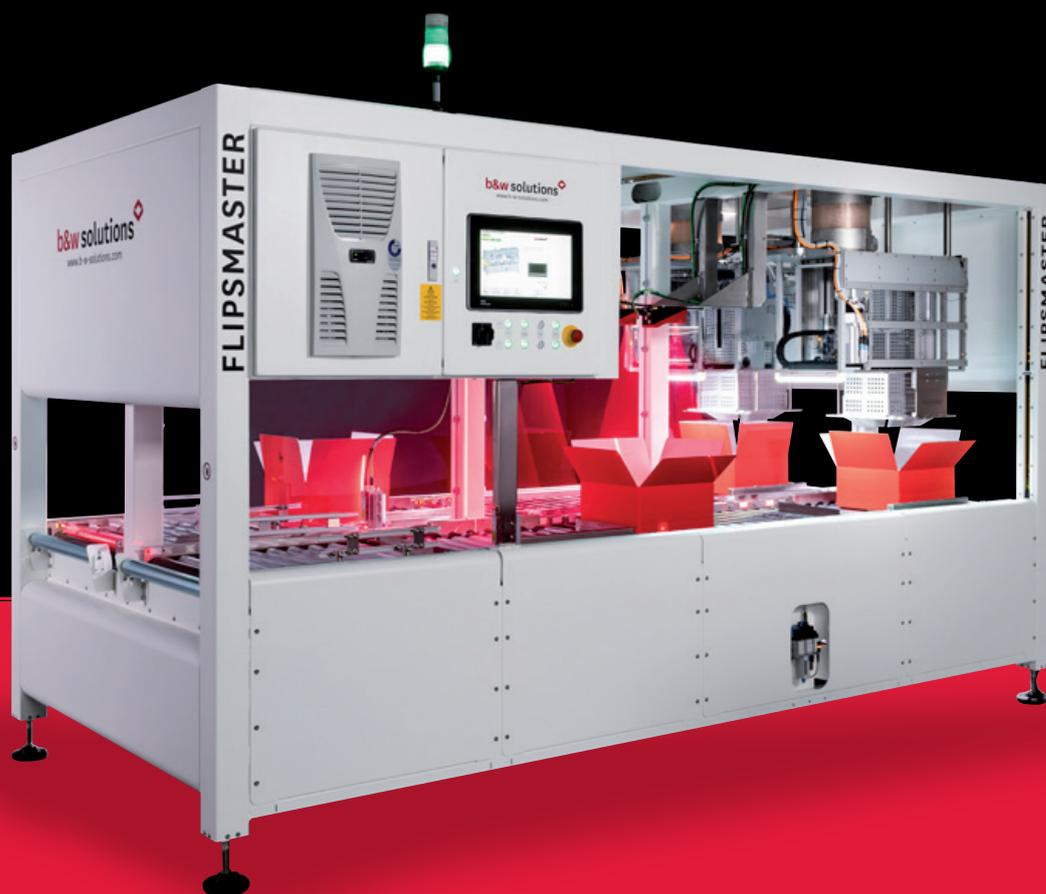
*Ermittlung des Restvolumens einlaufender Versandkartons und vollautomatische Befüllung mit der exakt erforderlichen Menge an Polstermaterial für den optimalen Transportschutz.*
