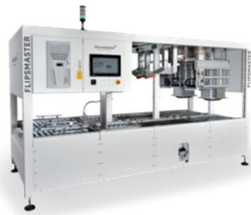
Die Maschine ermittelt mit 3D Laser Scannern das Restvolumen der einlaufenden Versandkartons und befüllt diese mit der exakt erforderlichen Menge an Polstermaterial für den optimalen Transportschutz. Während des Befüllens mit Verpackungschips vibriert der Karton um eine optimale Verteilung des Polstermaterials in alle Freiräume zu gewährleisten. Nicht korrekt befüllte Kartons können optional aussortiert werden.
