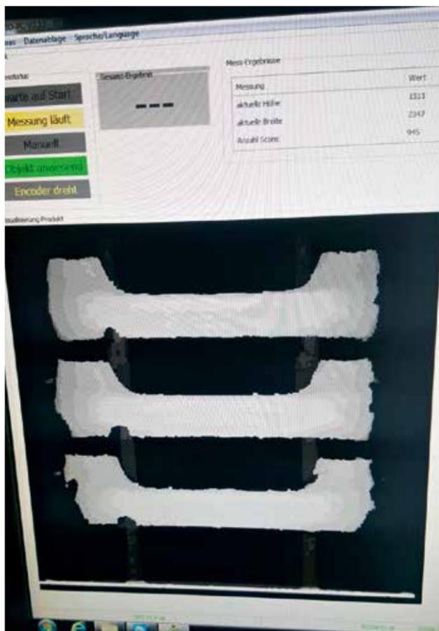
Messwerte bzw. „Scans“ werden von den Sensoren an ein PC-basiertes Auswertesystem gesendet und so ein 3D-Bild erstellt. Quelle: b&w
